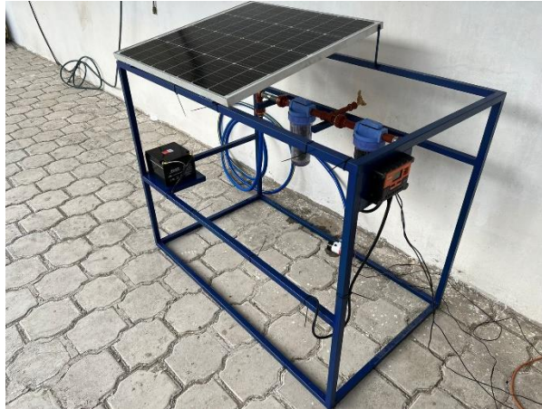
Ilustración 4-15: Equipo filtrante. Realizado por: Lema; Lizalde, 2024
