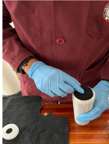
Ilustración 4-7: Colocación de la tela filtrante en la parte inferior de los cartuchos.
