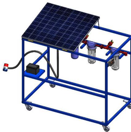
Ilustración 3-15: Equipo de filtración realizado en SolidWorks. Realizado por: Lema; Lizalde, 2024
