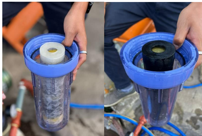
Ilustración 4-12: Colocación de cartuchos dentro de los filtros Realizado por: Lema; Lizalde, 2024
