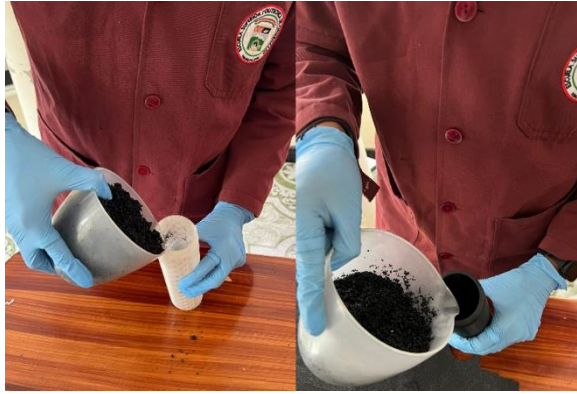
Ilustración 4-9: Llenado de cartuchos filtrantes con carbón activado.
