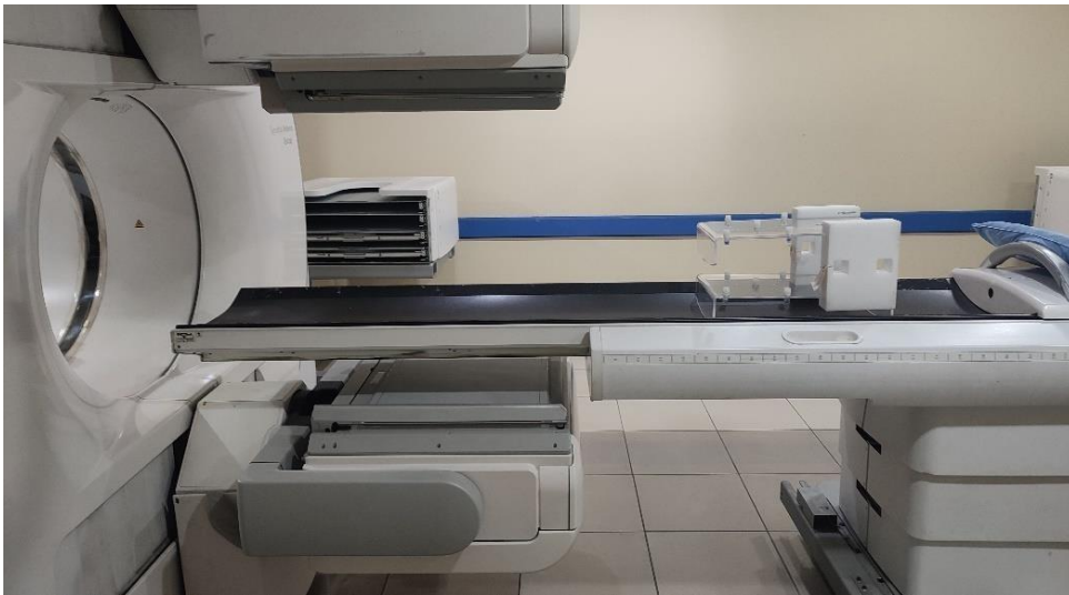
Ilustración 3-12 Colocación correcta del Fantoma ID534 SPECT/CT Symbia Intevo Excel en la camilla
