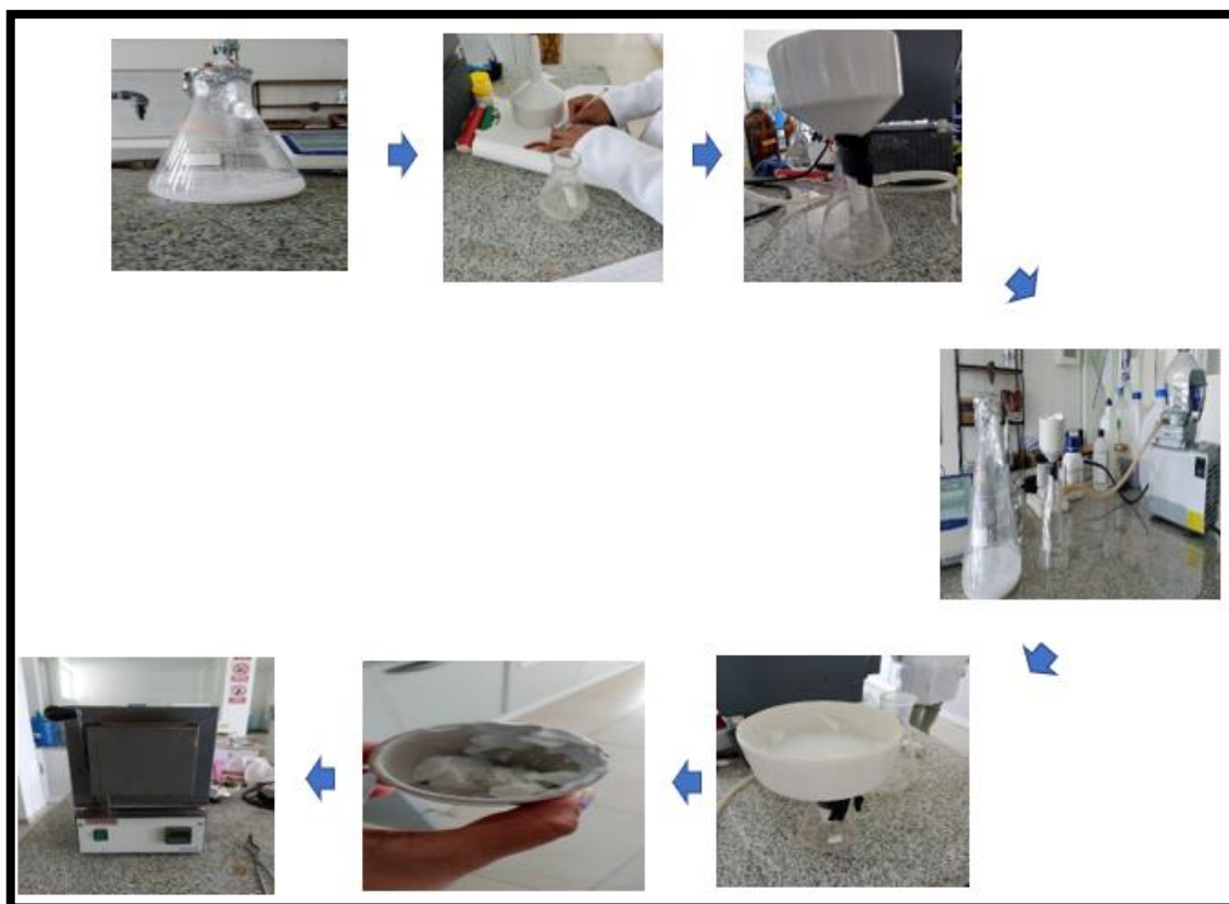
Ilustración 3-5: Preparación con los precursores para sintetizar dióxido de titanio
