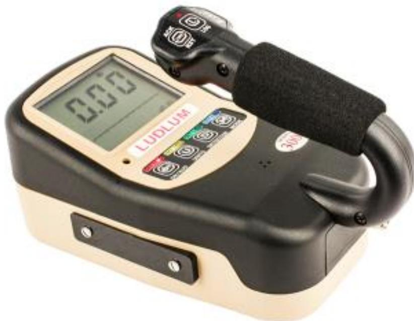
**Ilustración 7-3** Tacímetro multidetector marca LUDLUM modelo 3003.
