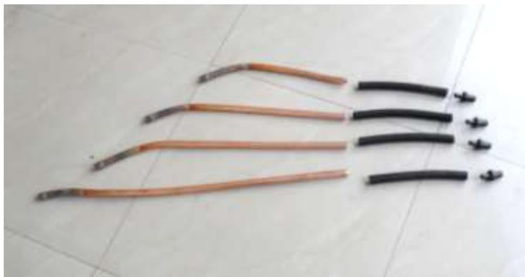
Con el fin de evitar que ingresen impurezas y partículas de polvo dentro del sistema por las uniones entre los acoples macho y las cañerías de cobre, estos dos elementos fueron soldados, para sellar cualquier fuga y obtener un sistema hermético. Con esto también
