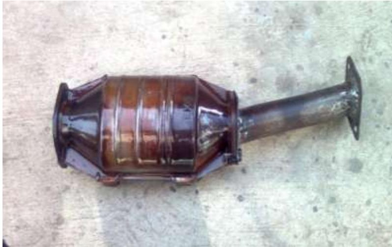
El convertidor catalítico queda montado sobre el sistema de escape como se observa en la figura No.57 a continuación.
