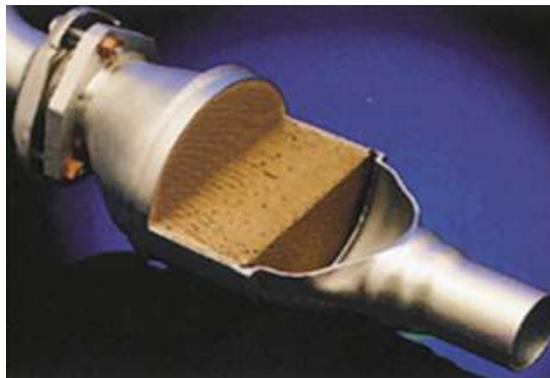
**De dos vías (reductor, de doble cuerpo):** es un doble catalizador de oxidación con toma intermedia de aire. El primer cuerpo actúa sobre los gases ricos del escape reduciendo los NOx. El segundo lo hace sobre los gases empobrecidos gracias a la toma intermedia de aire, reduciendo el CO y los hidrocarburos.
