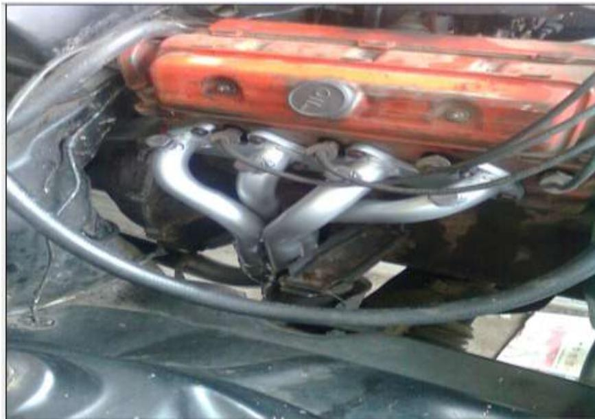
Para lograr ingresar aire dentro del sistema de escape se realizan perforaciones a un costado de cada tubo de salida de escape del header. Sobre esta perforación irán montados los acoples para las mangueras que transportarán el aire hasta el sistema de escape.
