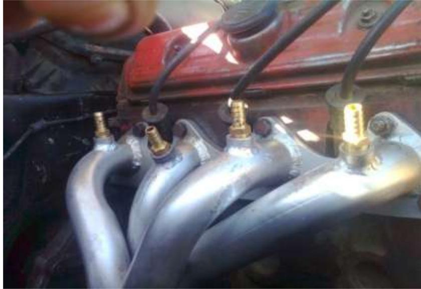
Luego de realizada la adaptación de los acoples sobre el header, resta incorporar el juego de válvulas accionadas por vacío.
