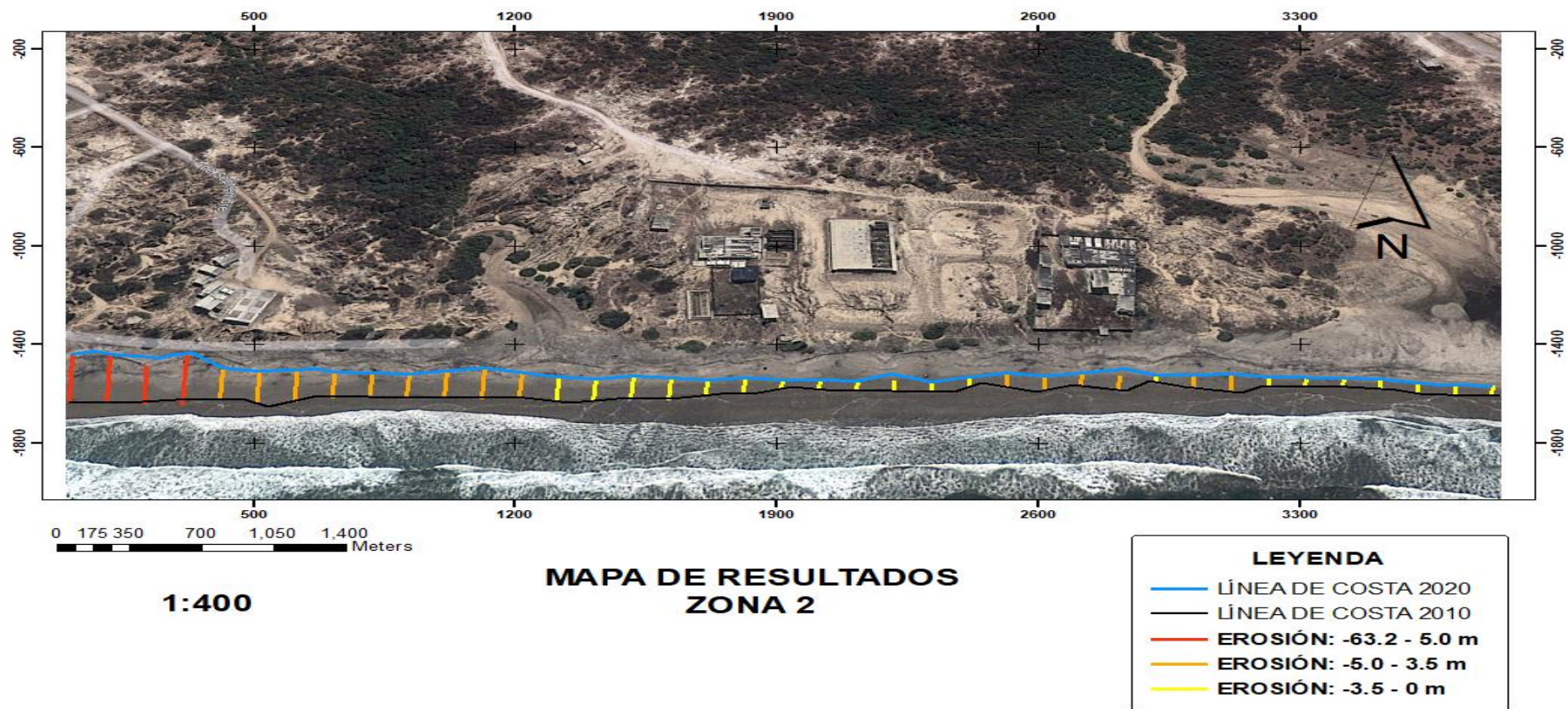
Ilustración 4-5: Desarrollo de la línea de costa de la zona 2, Engabao. Movimiento neto entre la línea de costa del año 2012 al 2020.
