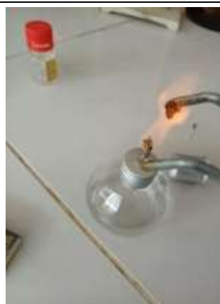
Fotografía N° 28. La película arde con la llama.
