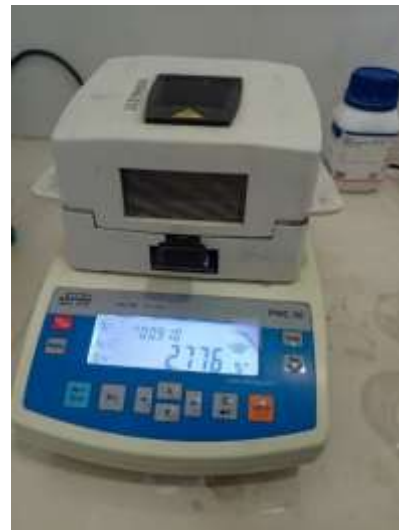
Fotografía N° 18. Análisis de humedad.
