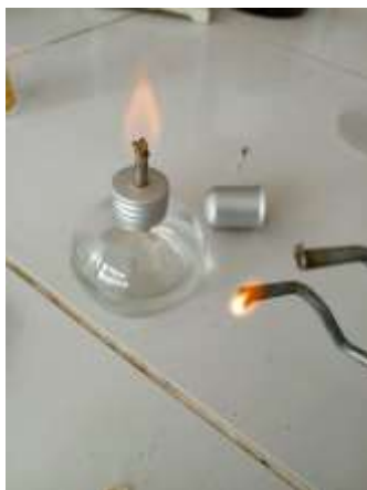
Fotografía N° 29. La película textil arde y continúa quemando al retirar de la llama.
