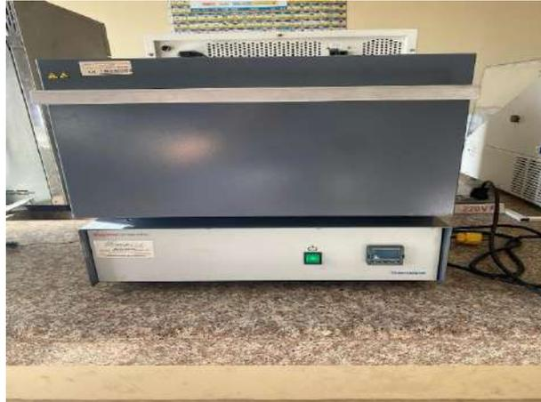
**Ilustración 3-18:** Calcinación a 800 °C de CaCO<sub>3</sub>
