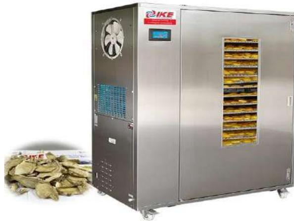
**Ilustración 3-23:** Secador de bandejas
