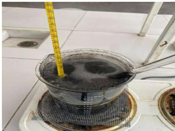
**Ilustración 3-14:** disolución de ceniza en ácido acético
