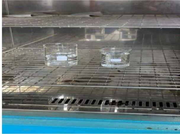
**Ilustración 3-16:** Evaporación de la solución
