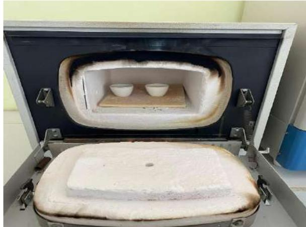
**Ilustración 3-13:** Calcinación de cáscara de huevo triturada
