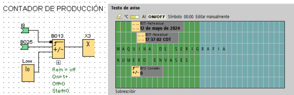
Ilustración 3-126: LOGO Soft Comfort - Programación y mensaje de activación del sistema conteo de productos.
