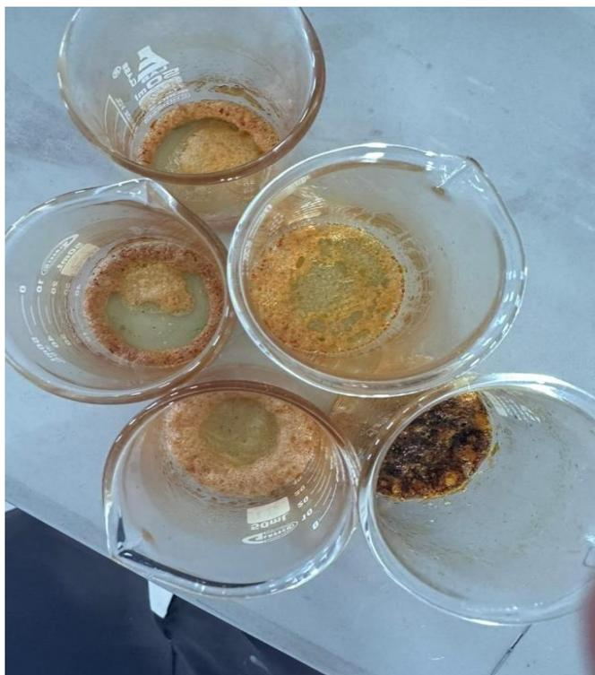
**Ilustración 4-5:** Cristales de  $\text{KNO}_3$  obtenidos por el método 1
