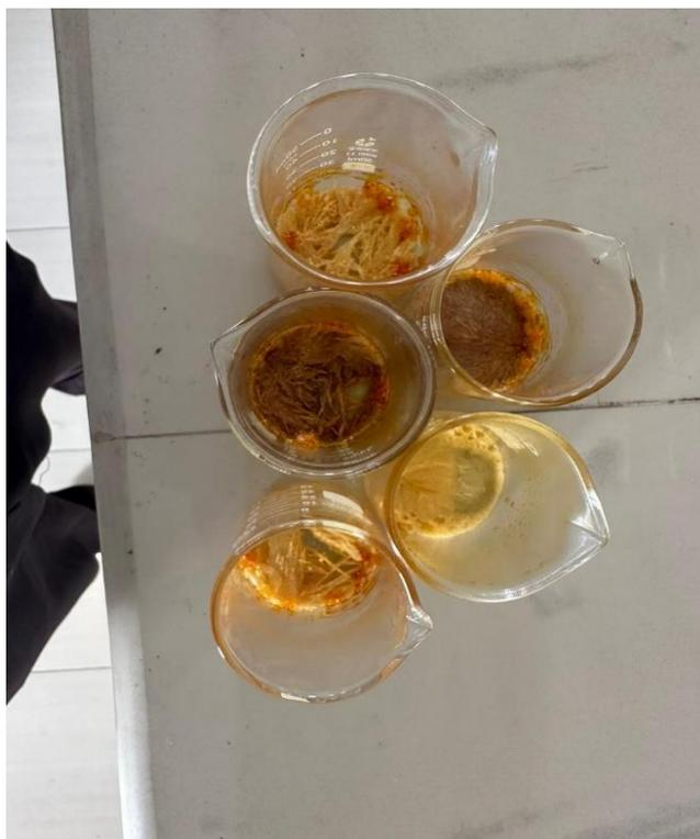
**Ilustración 4-6:** Cristales de  $\text{KNO}_3$  obtenidos por el método 2
