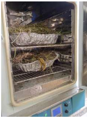
Ilustración 9: Secado de las muestras de suelo y forraje en la estufa a 105 ° C.
