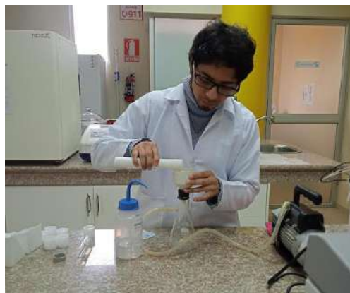
Ilustración 27: Filtración al vacío de las muestras llevadas al digestor asistida por microondas.
