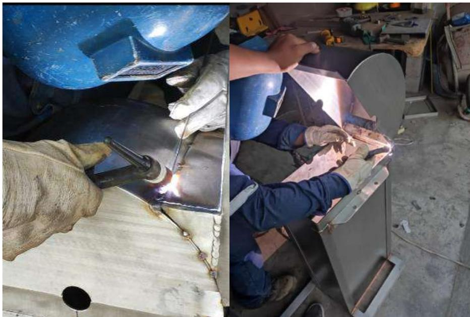
**Ilustración 3-58:** Soldadura con aporte proceso GTAW
