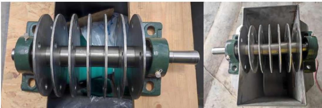
**Ilustración 3-59:** Montaje de los discos porta-martillos
