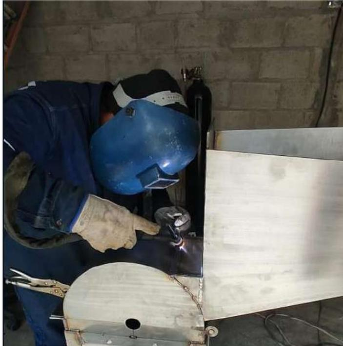
**Ilustración 3-57:** Montaje de la soldadura proceso GTAW
