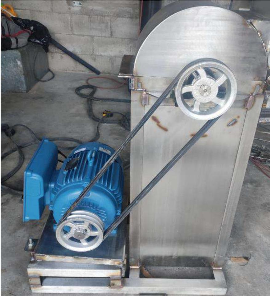
**Ilustración 3-61:** Montaje del sistema de transmisión
