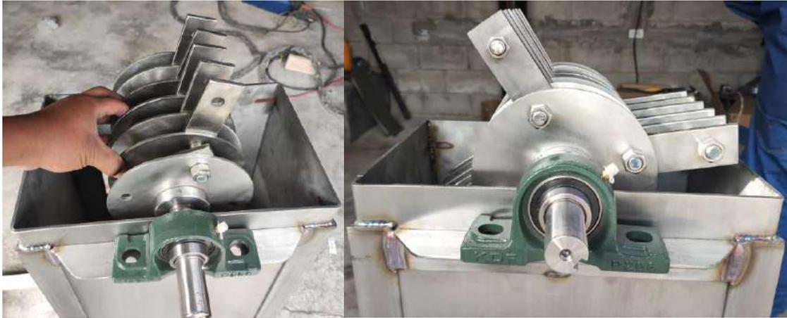
**Ilustración 3-60:** Montaje de la cámara de trituración en el bastidor
