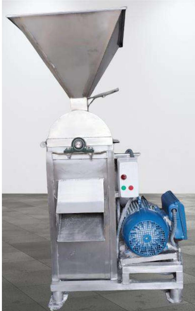
**Ilustración 3-62:** Ensamblaje total del molino de martillos
