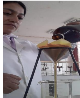
Filtración de los extractos
