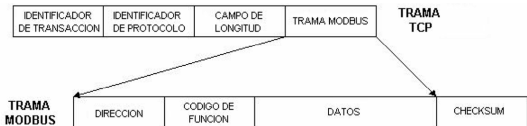
Figura III-6. Encapsulamiento de la trama Modbus/TCP
