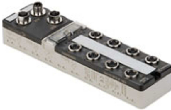
Figura III-12 Concentrador de señal SAI-AU M12 IE 16DI/8DO
