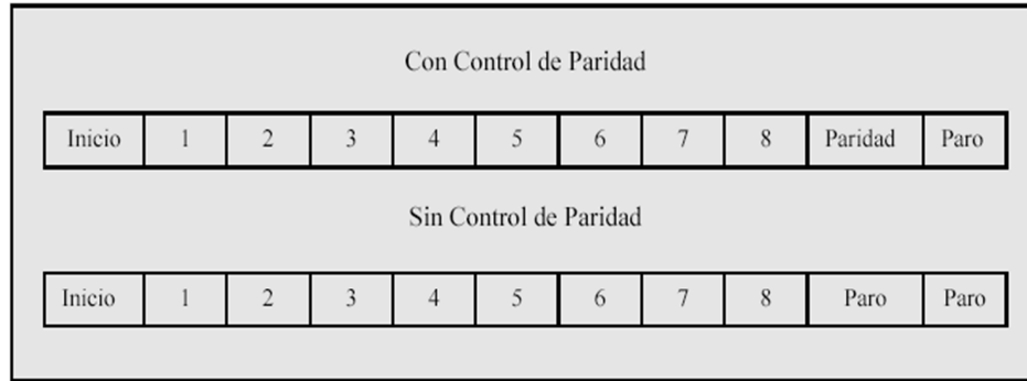
Figura III.10. Orden de bits (RTU)
