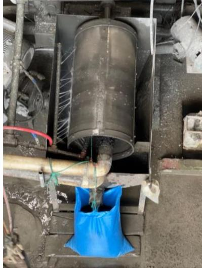
**Ilustración 4-11:** Recuperación del carbón activado de los tanques lixivadores.
