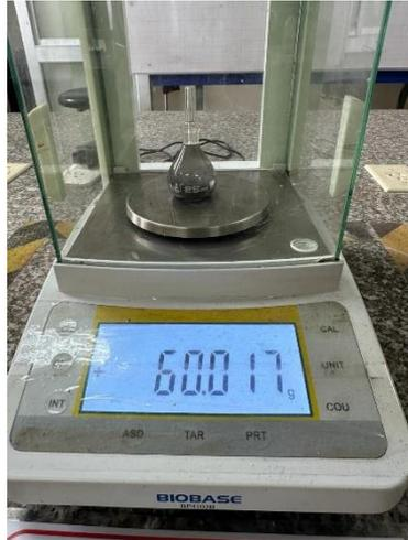
**Ilustración 3-8.** Ensayo de densidad del mineral de La Zamorana
