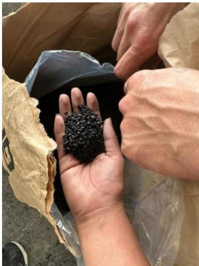
**Ilustración 4-10:** Adición de carbón activado al tanque.
