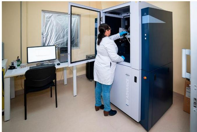
**Ilustración 3-2:** Difractómetro de rayos X D8 ADVANCE.
