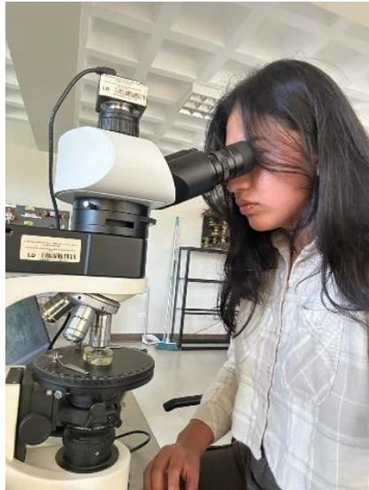
**Ilustración 3-5:** Análisis petrográfico de secciones pulidas en el microscopio OPTIKA B-510P.
