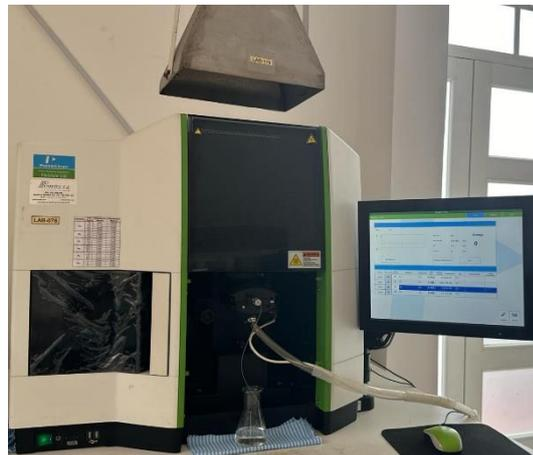
**Ilustración 3-7:** a) Toma de muestras en planta; y b) equipo de análisis de EAA.
