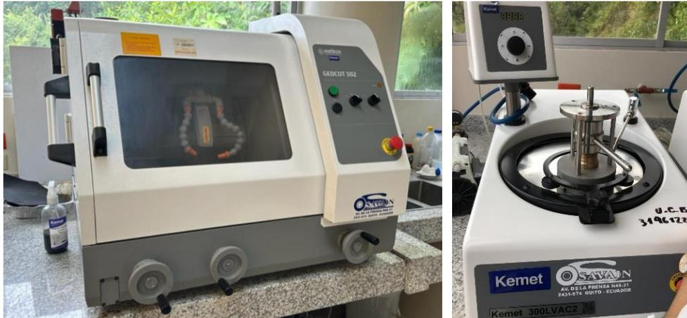
**Ilustración 3-4:** a) Cortadora GEOCUT 302; y b) Pulidora Kemet 300LVAC2.
