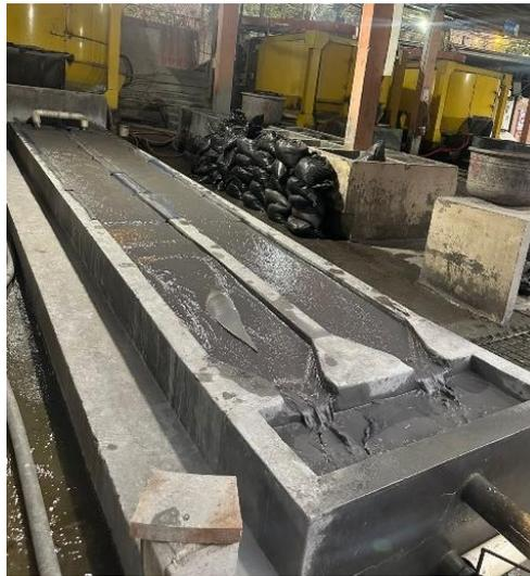
**Ilustración 4-5:** Canaletas de concentración gravimétrica.
