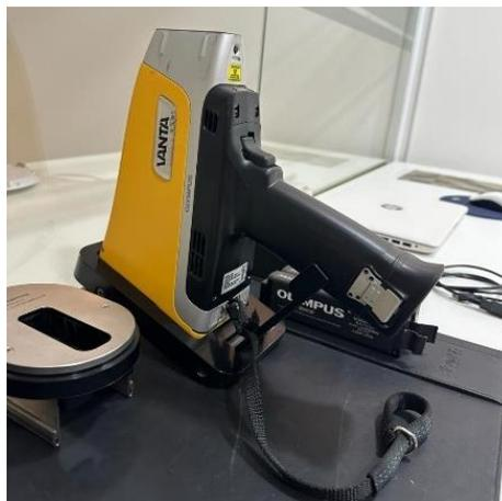
**Ilustración 3-3:** Difractómetro de fluorescencia de rayos X Vanta M Series.
