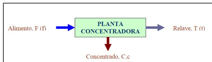
**Ilustración 2-19:** Esquema de una planta concentradora.
