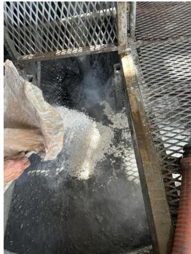
**Ilustración 4-7:** Adición de NaOH al proceso de lixiviación.
