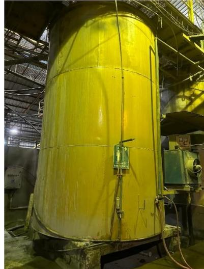
**Ilustración 3-6:** a) Canales para concentración gravimétrica; y b) Tanques agitadores para lixiviación.
