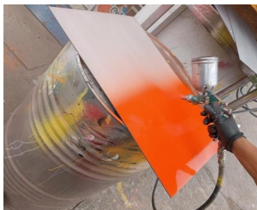
Ilustración 3-6: Capa protectora de pintura
