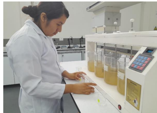
Dosificación de solución coagulante
