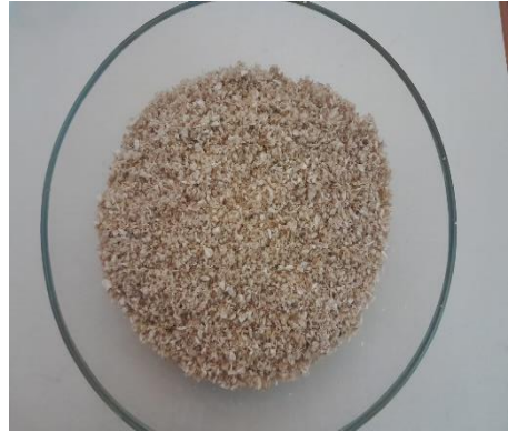
Obtención de coagulante natural en polvo
