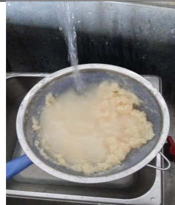
Imagen 14: Lavado de la pulpa blanqueada
