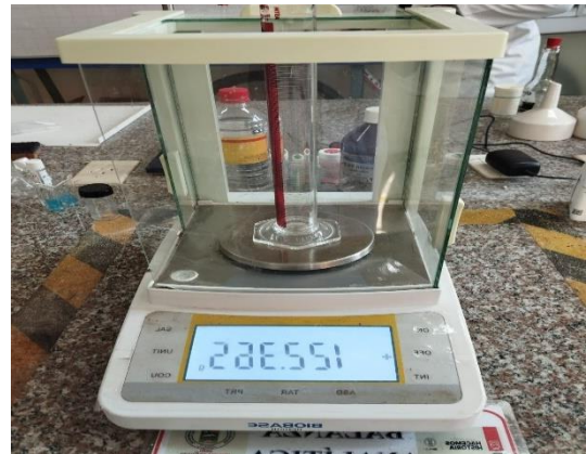
4. Pesaje de la probeta para determinar la densidad del suelo
