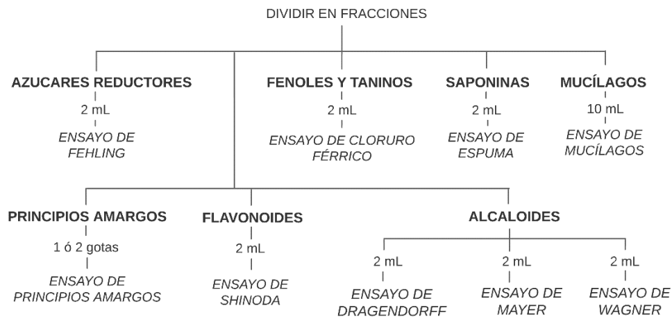
Ilustración 3- 6. Esquema de ensayos del extracto acuoso para el Tamizaje Fotoquímico
