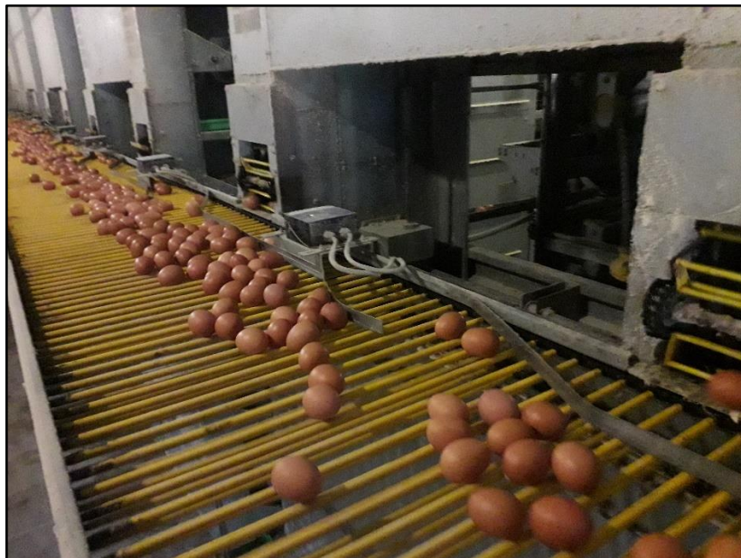
Banda transportadora transversal y contador de los galpones una por cada galpón.
