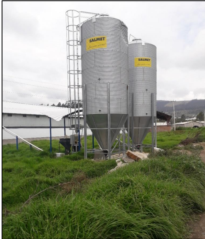
Silos y pesa en (gramos) de balanceado, para realizar el bacheo automático de la comida.
