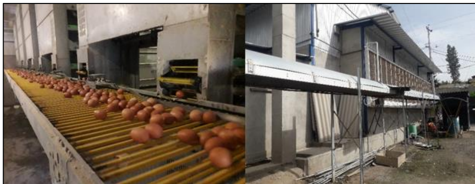
Figura 10-2: Banda transportadora del galpón hacia la bodega.
