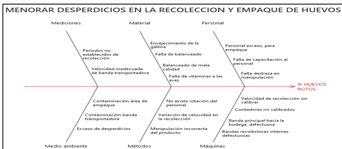
Gráfico 6- 3: Diagrama de Causa y Efecto para la cantidad de desperdicios Fuente: Avícola SANTA ELENITA SANTEEL Cía. Ltda.
