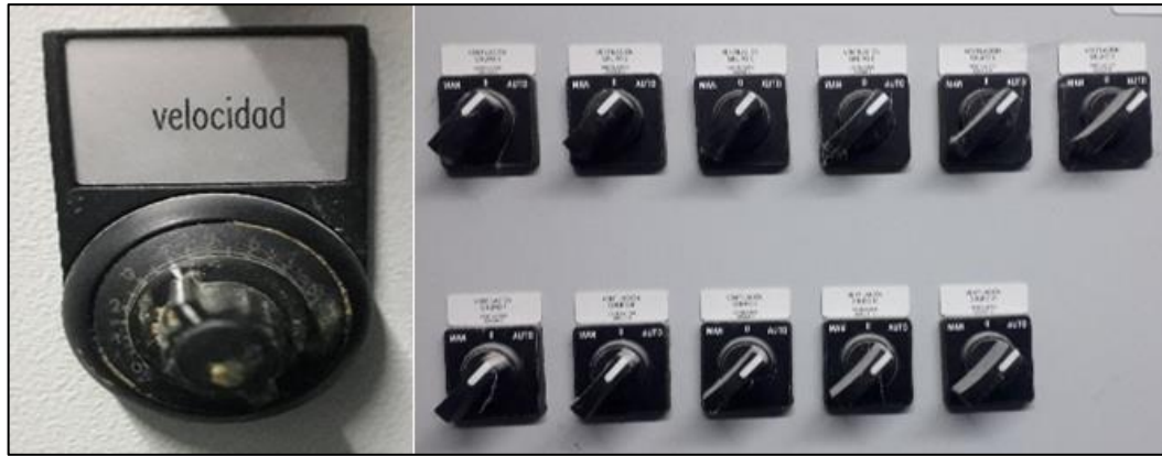
Figura 7-2: Control de recolección de huevos por filas y pisos (m/min).
