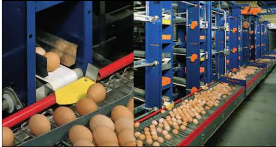
Figura 4-2: Sistema automático de recolección.
