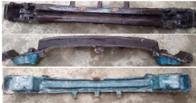
Figura 75-4. Inspección visual del parachoques fibra tejida
