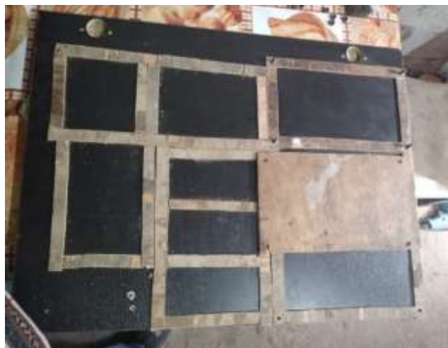
Figura 37-3. Construcción del molde para probetas
