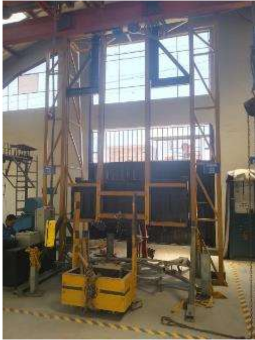
Figura 61-3. Péndulo de para configurado para ensayo de impacto
