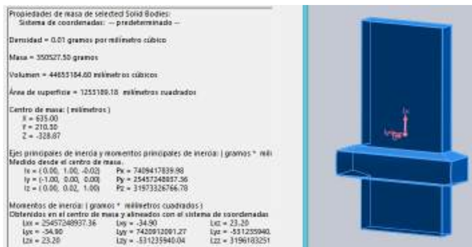
Figura 49-3. Centro de masa y peso del impactador (Acero Estructural)
