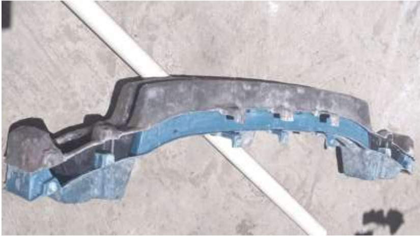
Figura 42-3. Fabricación del molde barra frontal del parachoques.
