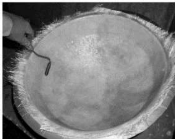
Figura 28-2. Fabricación por estratificación manual
