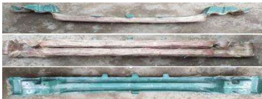
Figura 76-4. Inspección visual del parachoques fibra longitudinal
