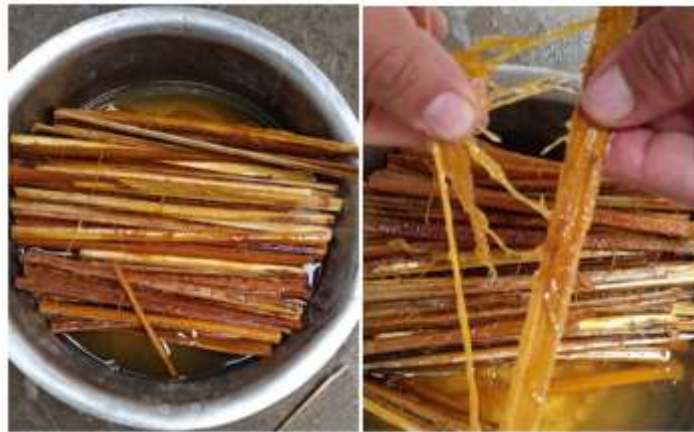
Figura 36-3. Tratamiento de la fibra en hidróxido de sodio
