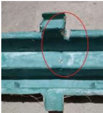
Figura 77-4. Fractura del parachoques con configuración de fibra unidireccional
