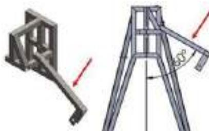
**Figura 16-3.** Barra ubicada a 60° con relación al eje vertical del equipo.
