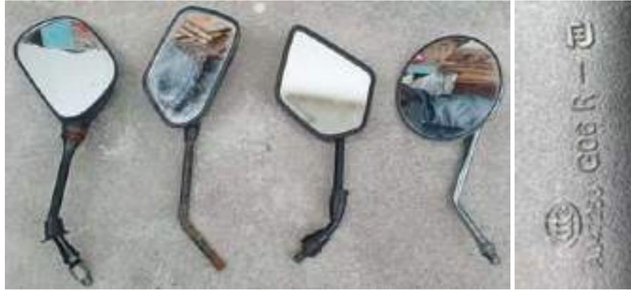
**Figura 39-4.** Espejos retrovisores con marca de homologación.
