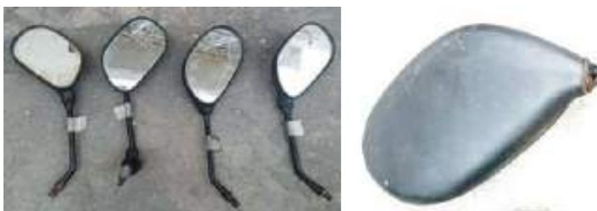
**Figura 38-4.** Espejos retrovisores sin marca de homologación.
