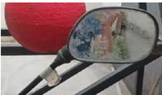
**Figura 44-4.** Espejo retrovisor #4 sin marca de homologación, después del ensayo.
