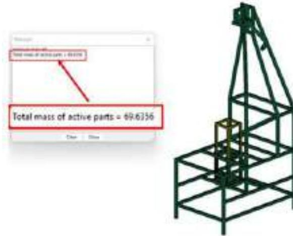
**Figura 36-3.** Masa total de la estructura con mesa elevadora en el punto más alto.
