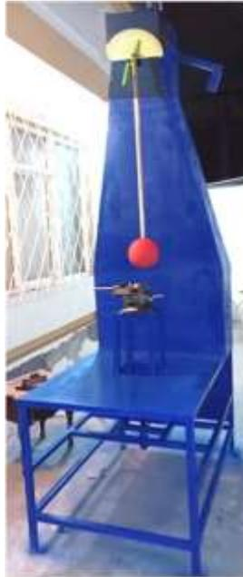
**Figura 1-5.** Equipo para ensayo de impacto.
