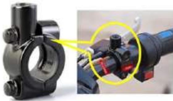
**Figura 22-4.** Soporte de montaje de espejo retrovisor.
