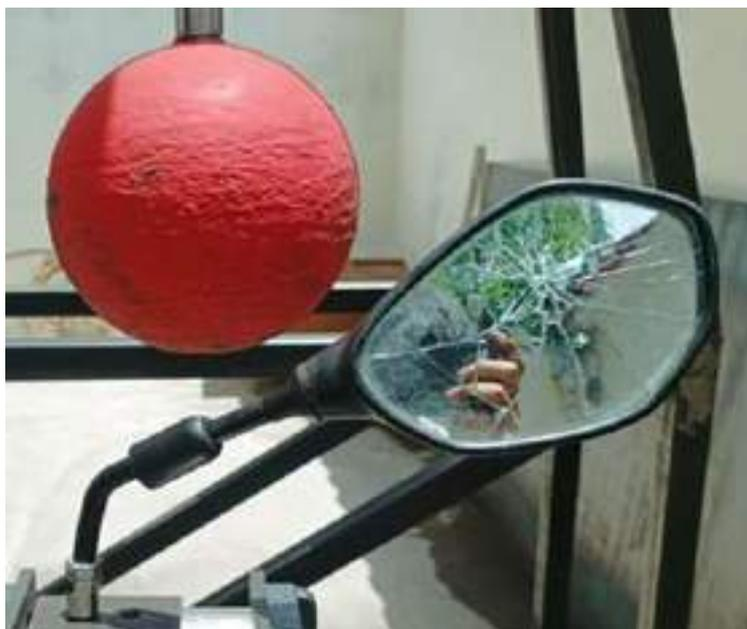
**Figura 40-4.** Espejos retrovisores con marca de homologación, ensayado previamente.
