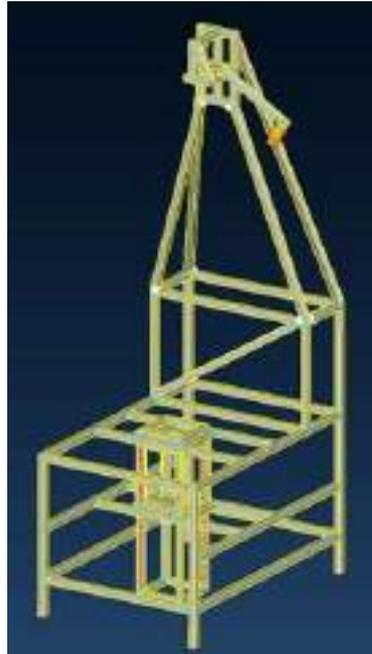
**Figura 10-3.** Estructura compartida topológicamente en todas sus uniones.
