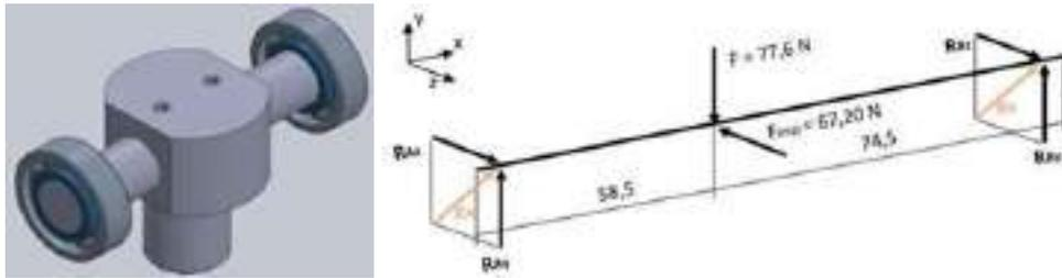
**Figura 21-3.** Eje con sus apoyos y DCL en el plano x-z.
