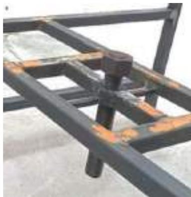
**Figura 8-4.** Tornillo para la regulación del soporte desplazable.
