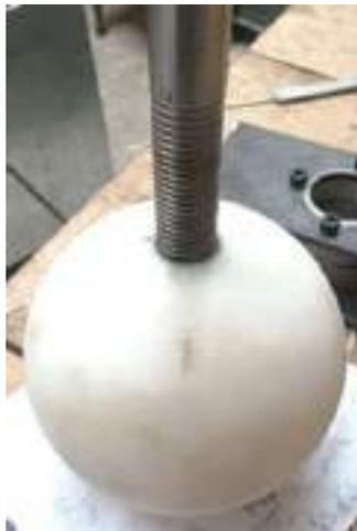
**Figura 11-4.** Acoplamiento de la barra y la esfera (péndulo).
