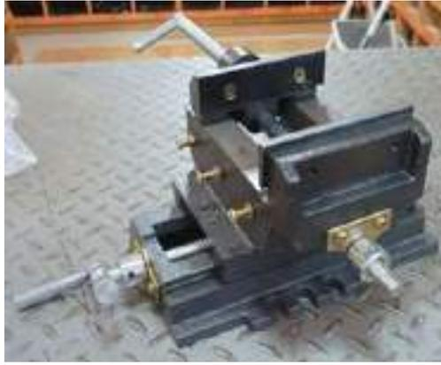
**Figura 16-4.** Prensa transversal de 4 pulgadas.
