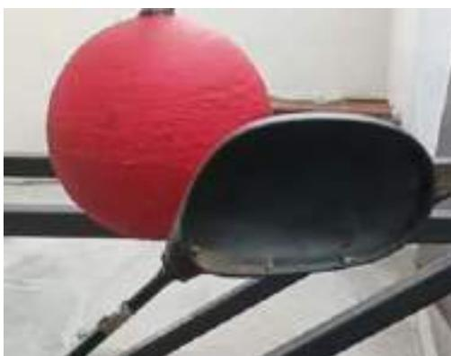
**Figura 43-4.** Espejo retrovisor #3 sin marca de homologación, después del ensayo.
