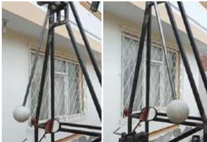
**Figura 21-4.** Oscilación del péndulo hacia el lado izquierdo y derecho del equipo.
