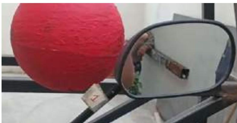
**Figura 41-4.** Espejo retrovisor #1 sin marca de homologación, después del ensayo.
