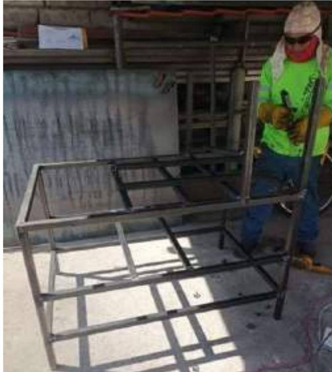
**Figura 3-4.** Unión de los componentes de la estructura mediante soldadura.
