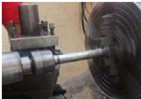
**Figura 12-4.** Torneado del eje del péndulo.
