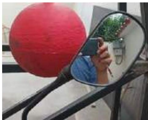
**Figura 46-4.** Segundo espejo retrovisor con marca de homologación, después del ensayo.
