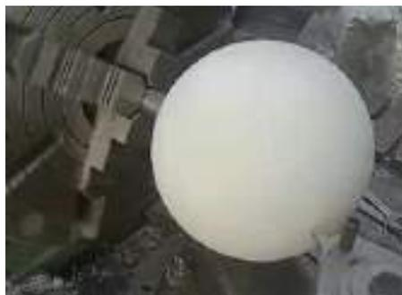
**Figura 9-4.** Maquinado de la esfera del péndulo.
