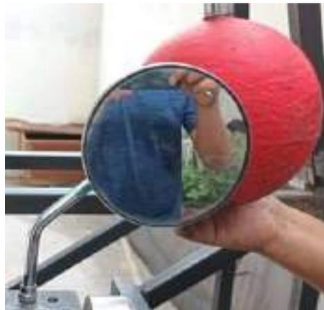
**Figura 45-4.** Primer espejo retrovisor con marca de homologación, después del ensayo.
