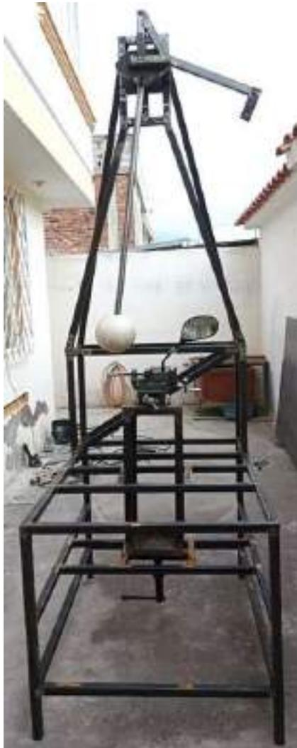
**Figura 17-4.** Equipo de ensayo de impacto.
