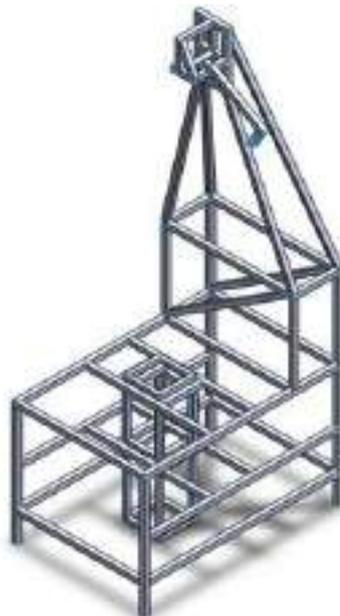
**Figura 9-3.** Estructura principal del dispositivo de ensayo en tipo superficie.
