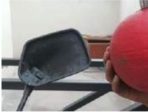
**Figura 47-4.** Tercer espejo retrovisor con marca de homologación, después del ensayo.
