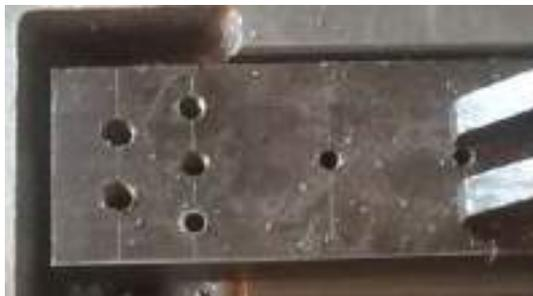
**Figura 14-4.** Placa con perforaciones para roscar.
