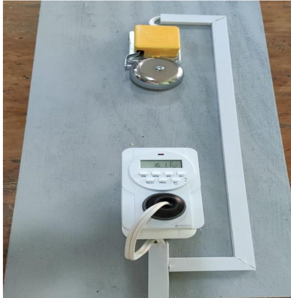
Ilustración 4-7: Temporizador programable junto a zumbador con campana
