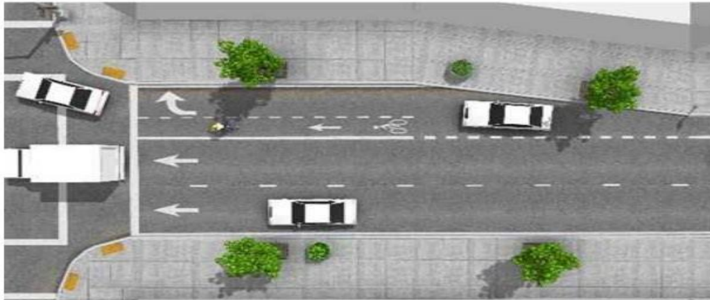
Figura 35-5: Señalización de carril bicicleta, en intersección
