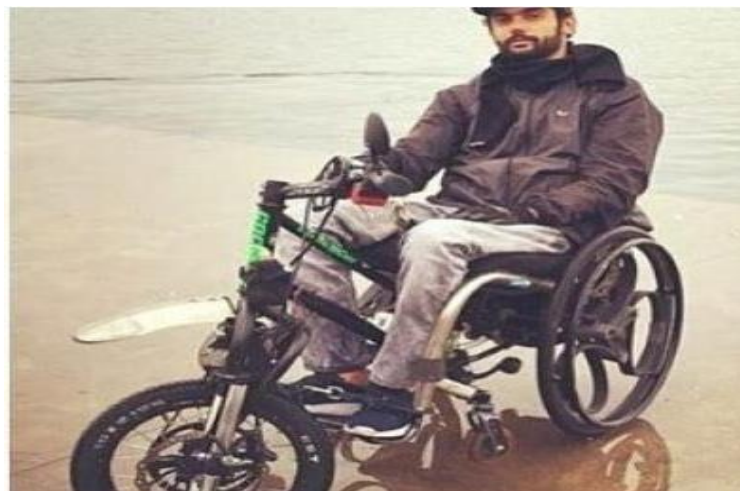
Figura 15-2: Vehículo Mitad Silla de Ruedas y Mitad Bicicleta Eléctrica
