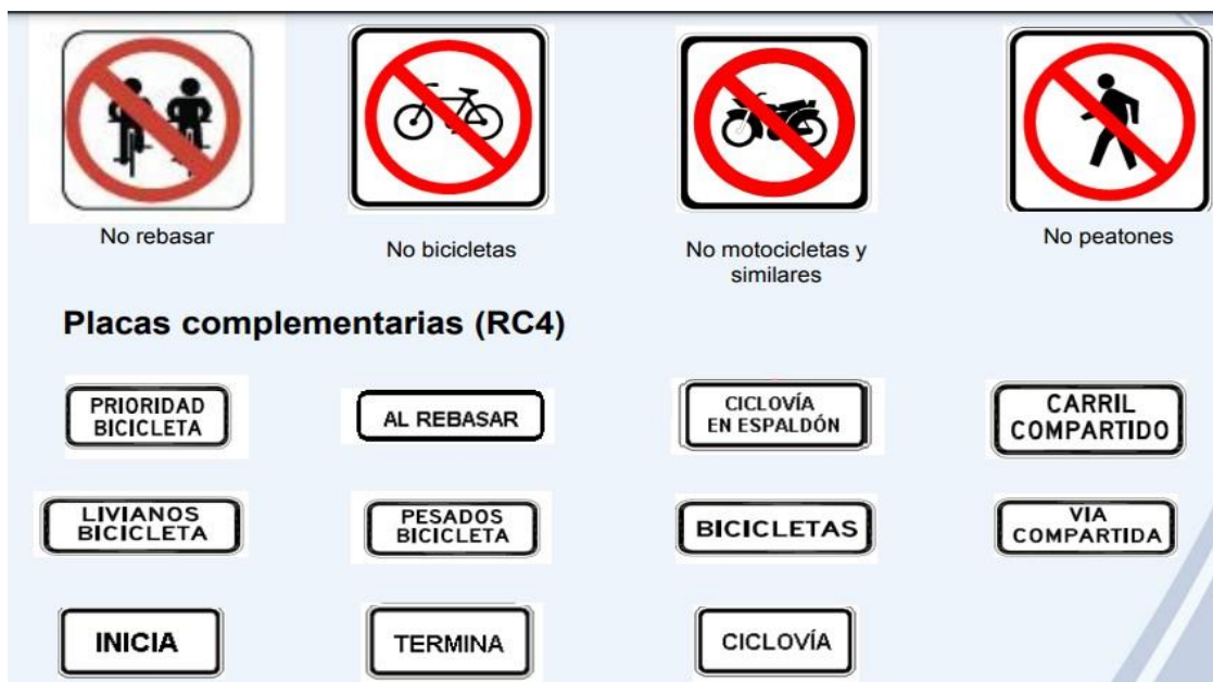
Figura 58-5: Señalización vertical que restringe la circulación, así como la utilización de placas complementarias.
