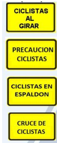
Figura 59-5: Señales que advierten a los usuarios de las vías que se aproximan a una ruta donde existen usuarios de ciclo vía.
