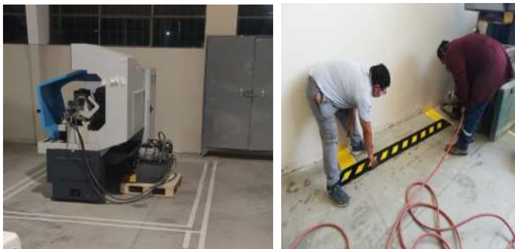
Ilustración 3-26: Demarcación de espacios de máquinas y estanterías
