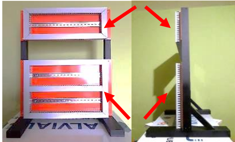
Ilustración 3-33: Colocación de canaletas ranuradas y rieles DIN
