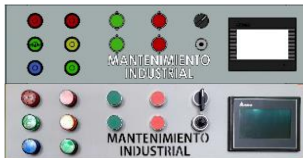
Ilustración 4-5: Colocación de los dispositivos en la botonera
