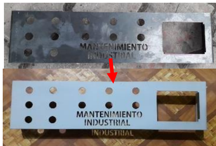
Ilustración 3-34: Corte y pintado de la plancha metálica
