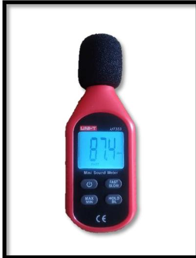
**Ilustración 3-1:** Sonómetro (instrumento de medición de ruido).
