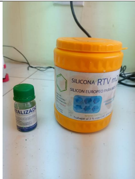
Fotografía N°3. Material de inyección (Silicona RTV y catalizador).
