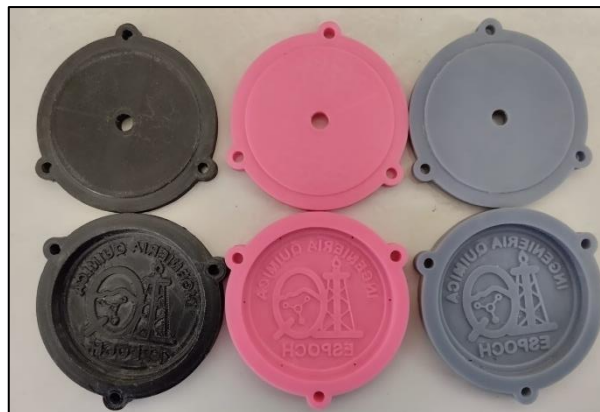
Ilustración 4-4: Moldes impresos en FDM (PETG), FDM (PLA) Y SLA (Resina estándar)
