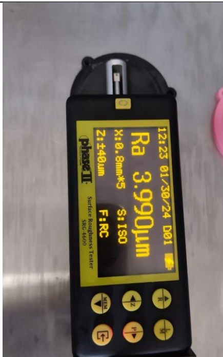
Fotografía N°8. Medición de la profundidad de las letras del molde.
