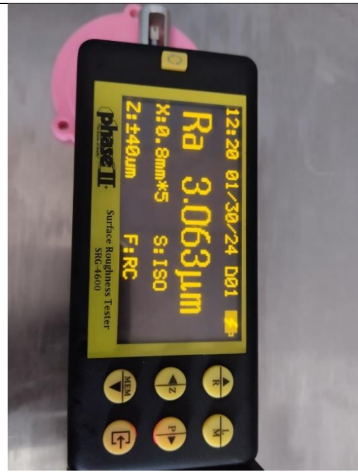
Fotografía N°9. Medición de la rugosidad del molde de PLA después de la primera inyección.
