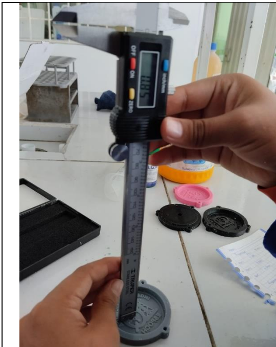
Fotografía N°8. Medición de la profundidad de las letras del molde.
