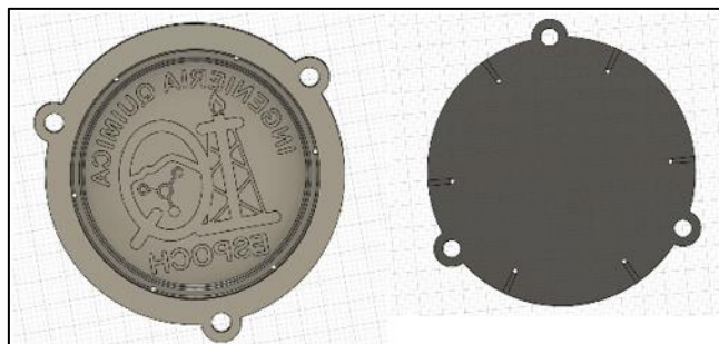
Ilustración 4-2: Vista superior e inferior del cuerpo del molde
