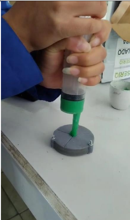
Fotografía N°6. Inyección de silicón.
