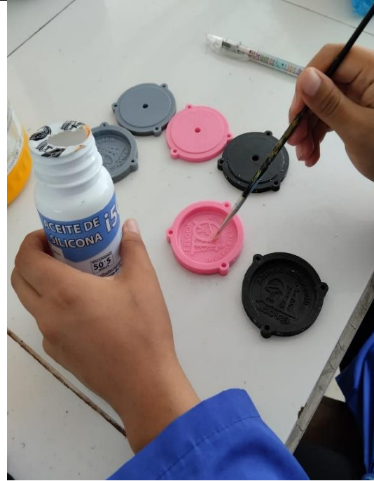
Fotografía N°5. Untamiento de aceite de silicona (desmoldante) sobre los moldes.
