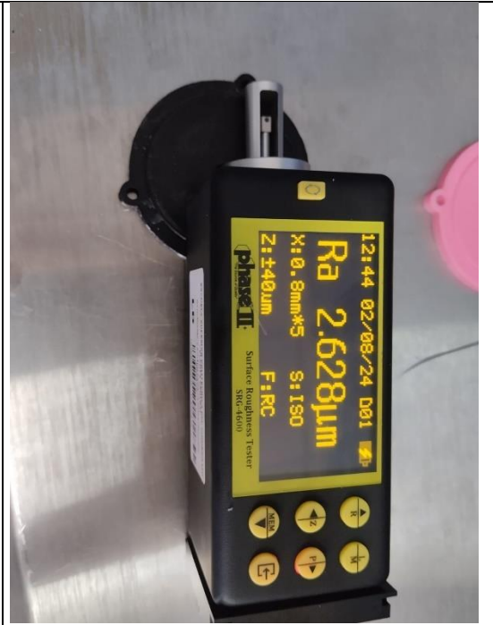
Fotografía N°13. Medición de la rugosidad del molde de PETg después de la quinceava inyección.
