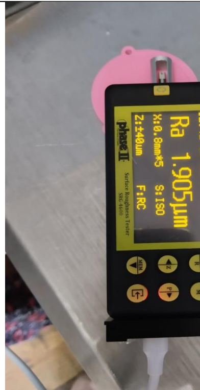
Fotografía N°15. Medición de la rugosidad del molde de PLA después de la treintava inyección.
