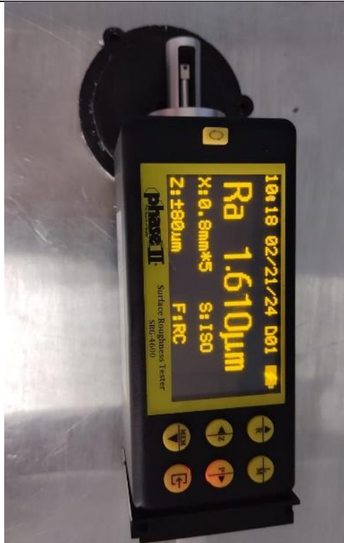
Fotografía N°16. Medición de la rugosidad del molde de PETg después de la treintava inyección.
