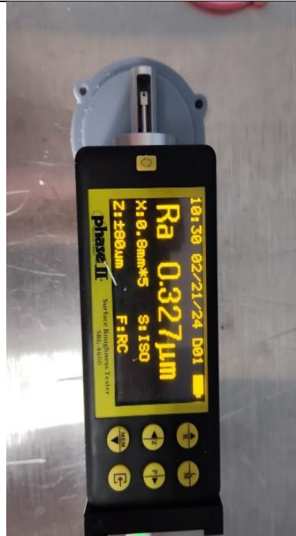
Fotografía N°17. Medición de la rugosidad del molde de resina después de la treintava inyección.
