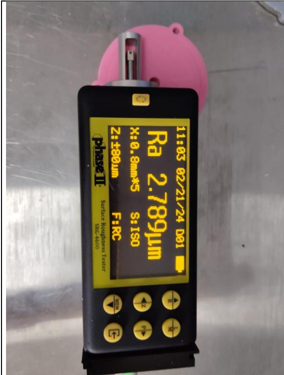
Fotografía N°12. Medición de la rugosidad del molde de PLA después de la quinceava inyección.
