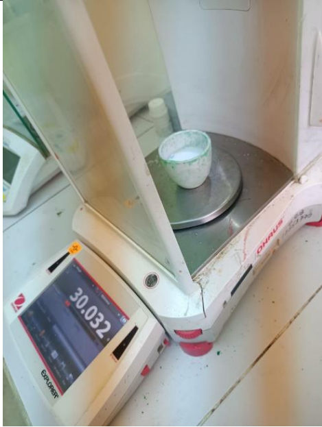
Fotografía N°4. Pesado de la silicona RTV y el catalizador.
