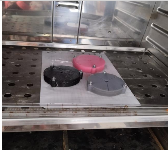
Fotografía N°5. Untamiento de aceite de silicona (desmoldante) sobre los moldes.
