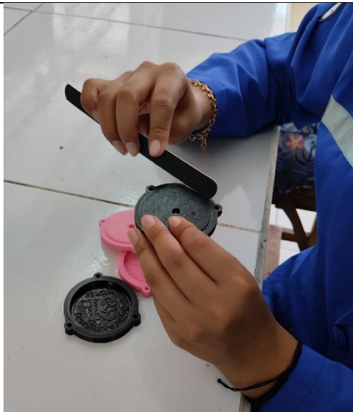
Fotografía N°2. Pulido y retirado de excesos en los moldes.
