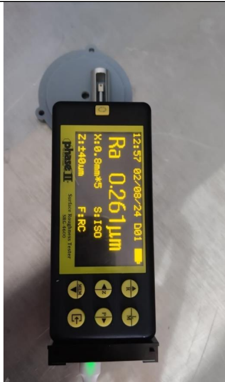
Fotografía N°14. Medición de la rugosidad del molde de resina después de la quinceava inyección.
