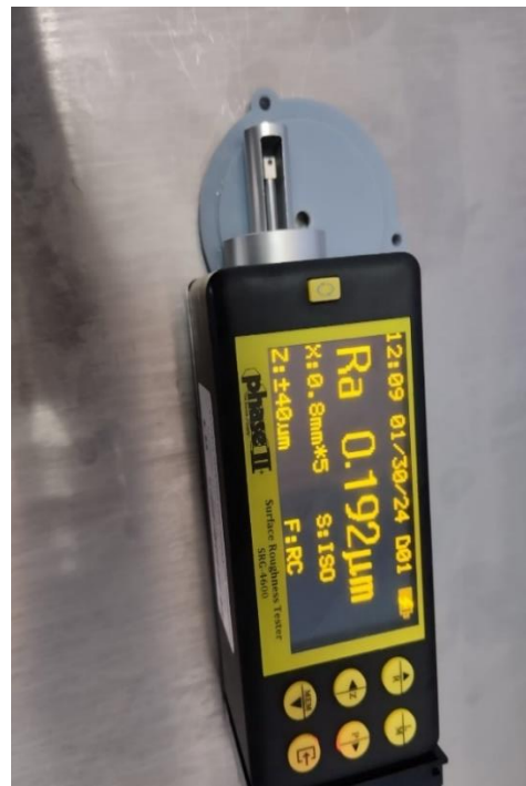
Fotografía N°11. Medición de la rugosidad del molde de resina después de la primera inyección.
