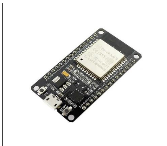
Ilustración 2-18: Tarjeta de desarrollo ESP32
