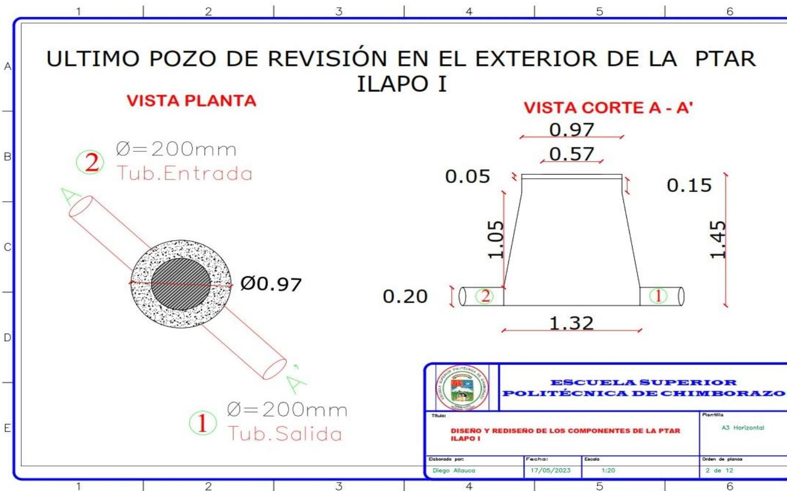
**Ilustración 4-10:** Ultimo pozo de revisión en el exterior de la PTAR Ilapo I
