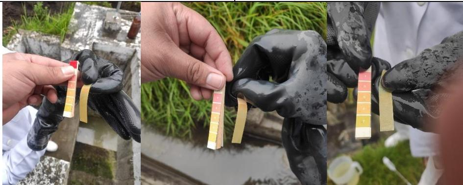
C. Medición del pH en diferentes puntos de la PTAR
