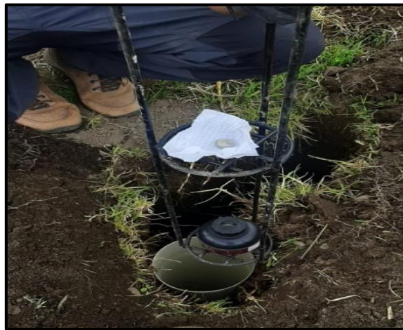
Ilustración 2-10: Instalación de la configuración experimental que mide la concentración del radón y la temperatura
