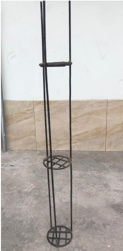
La estructura para colocar los equipos en el tubo
