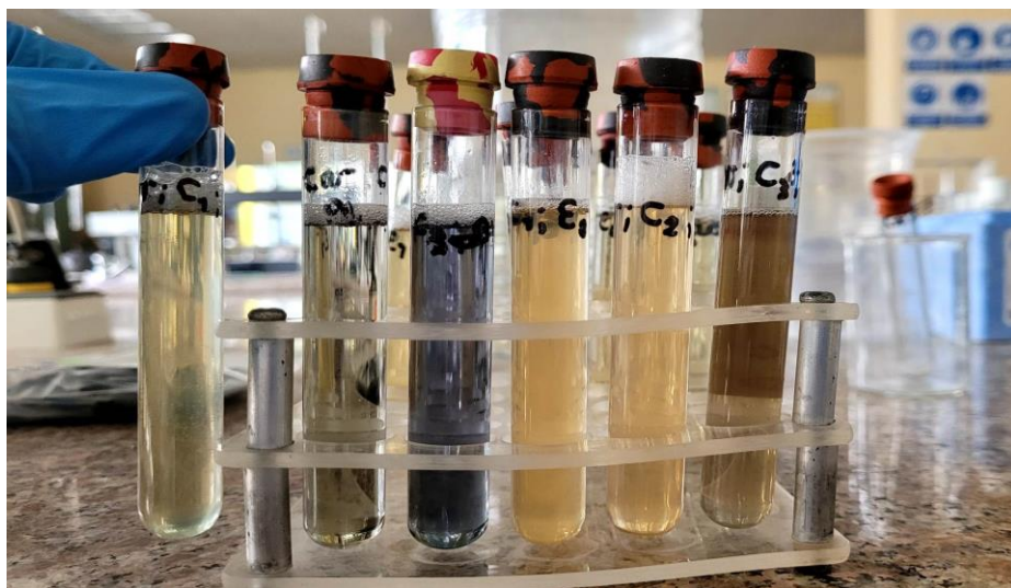
Ilustración 12-3: Determinación de cianuro en pruebas de degradación. De izquierda a derecha: blanco C1; blanco C2; blanco C3; muestra C1, E2; muestra C2, E2; y muestra C3, E2.
