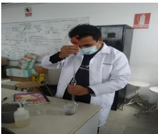
Toma de la muestra filtrada para el análisis de P
