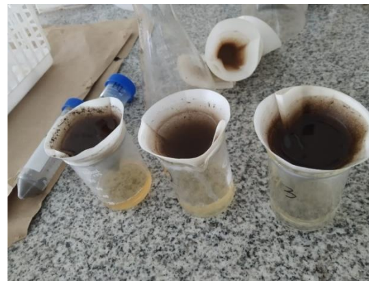
Determinación de P mediante el método Ólsen
