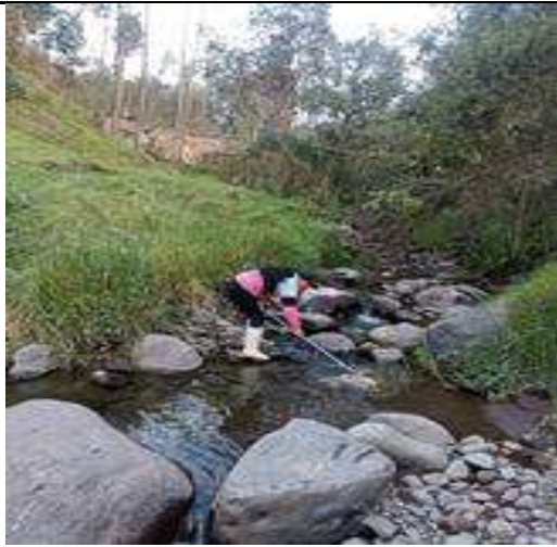
Utilización de la red tipo D para la recolección de macroinvertebrados
