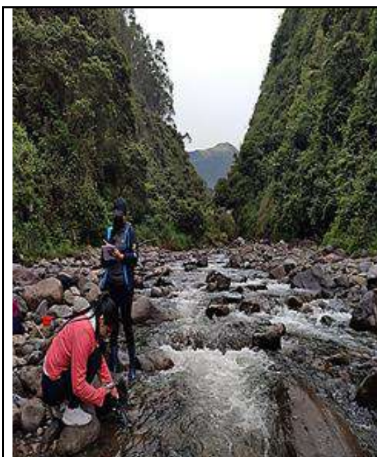
Medición de la temperatura, Ph, Sólidos Disueltos Totales, Oxígeno Disuelto y salinidad en el contribuyente Guayllabamba.
