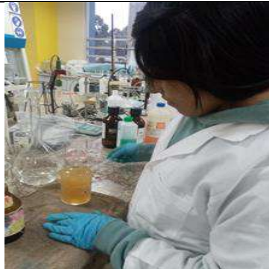
Preparación de reactivos para la determinación de DBO5.
