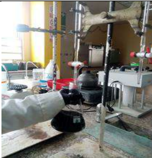
Determinación de la DBO5 - Laboratorio de Calidad del Agua ESPOCH
