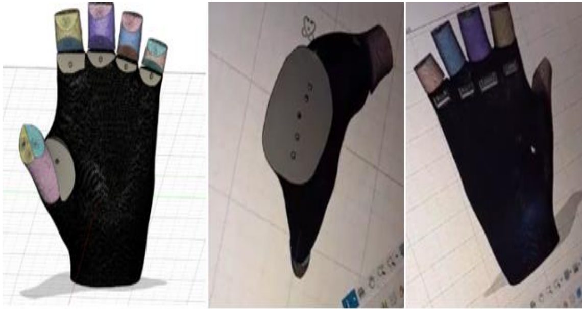
Ilustración 3-16: Diseño de la inserción de elásticos para el movimiento de la mano.
