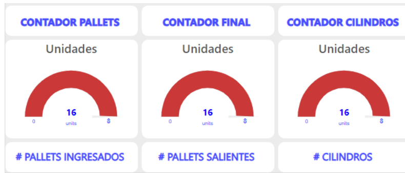
Ilustración 4-14: Contador visualizado en Node-Red del segundo ciclo de ejecución
