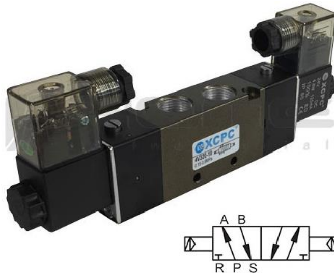
Ilustración 2-2: Electroválvula neumática 5/2 Puertos 3/8"
