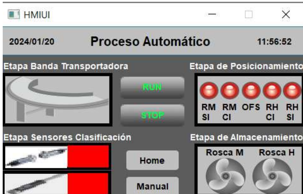
Ilustración 3-78: Pantalla de Funcionamiento del módulo en proceso Automático.
