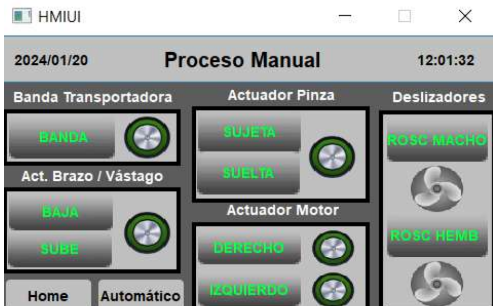
Ilustración 3-79: Pantalla de Funcionamiento del módulo en proceso Manual.
