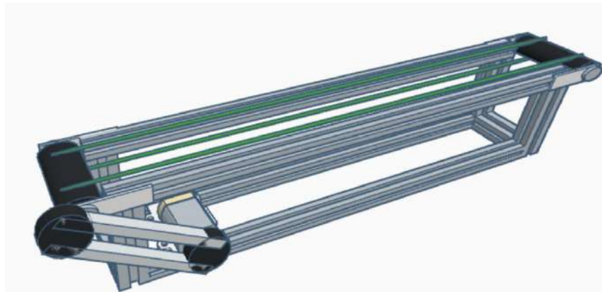
Ilustración 1-3: Banda transportadora con accionamiento por medio de un motor paso a paso.
