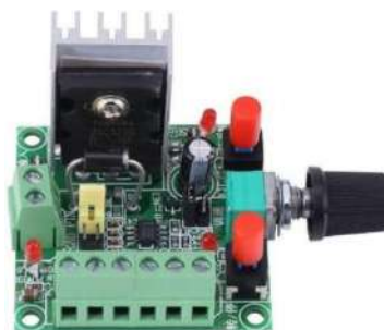
Ilustración 3-16: Controlador de motor paso a paso, PWM Regulador de velocidad del generador de señales.
