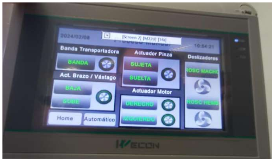
Figura 9: Sección de HMI, modo manual
