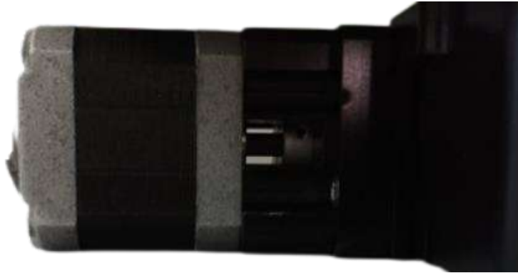
Ilustración 3-22: Motor paso a paso STP-43D2035
