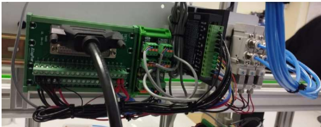
Ilustración 3-39: Ensamblaje físico del módulo de válvulas
