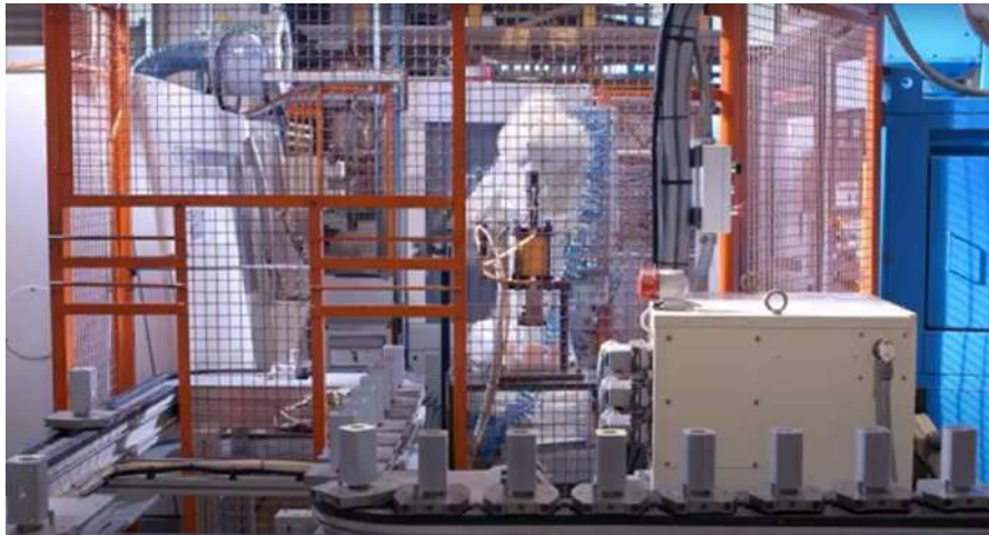
Ilustración 4-4: Línea de producción automatizada de actuadores neumáticos
