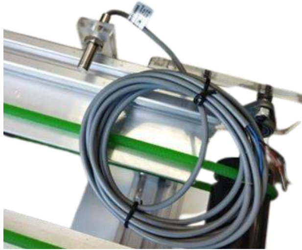
Ilustración 3-12: Sensor inductivo de proximidad LJ6A3-1-P1
