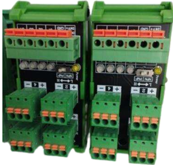
Ilustración 3-11: Bloque de terminales de sensor de 4 posiciones
