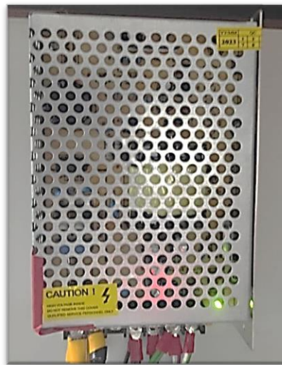
Ilustración 3-17: Fuente de poder 12V – 10 A.
