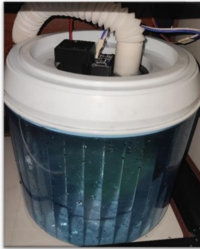
Ilustración 3-42: Implementación física del sistema de humidificación.
