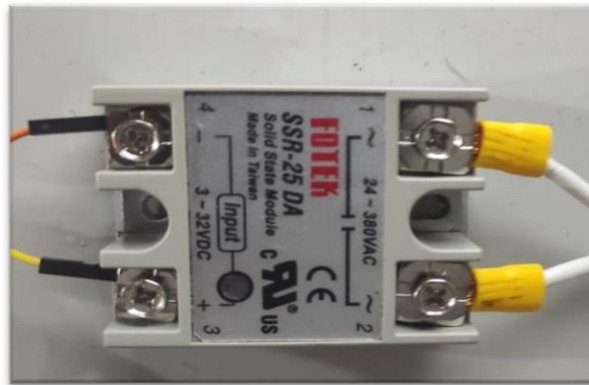
Ilustración 3-13: Relé de estado sólido SSR-25 DA.
