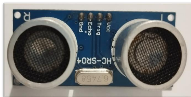
Ilustración 3-6: Sensor de distancia ultrasónico HC-SR04.
