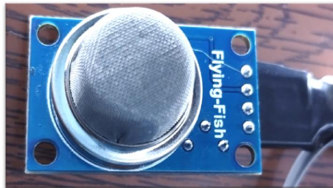
Ilustración 3-5: Sensor de calidad de aire MQ135.
