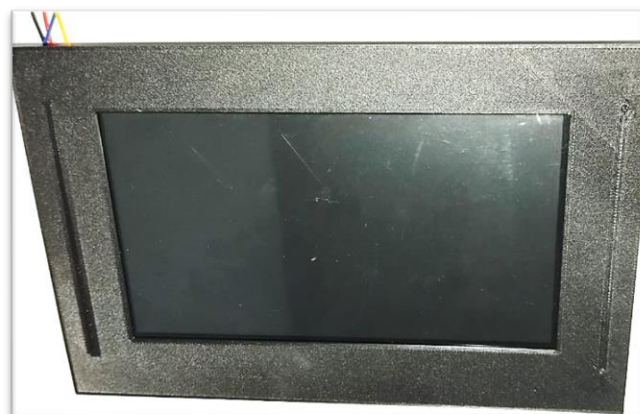
Ilustración 3-8: HMI Nextion 7.0 NX8048P070-011C.
