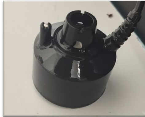
Ilustración 3-11: Humidificador ultrasónico 24V DC.
