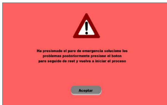
Ilustración 3-34: Pantalla de emergencia
