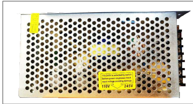
Ilustración 3-7: Fuente de poder conmutada 24V
