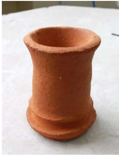
Ilustración 4-18: Pieza cerámica al finalizar el proceso de cocción
