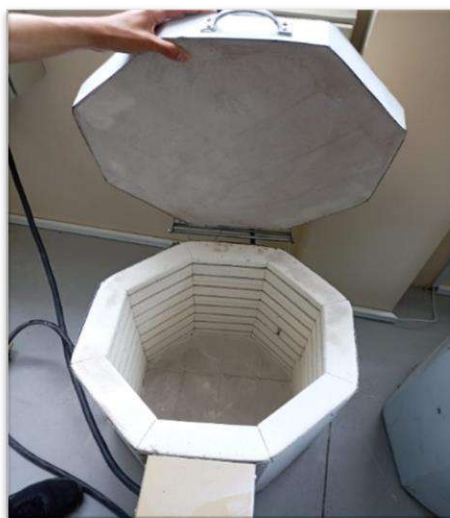
Ilustración 3-12: Horno eléctrico con abertura superior
