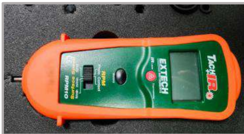
Ilustración 4-14: Tacómetro Exttech RPM10
