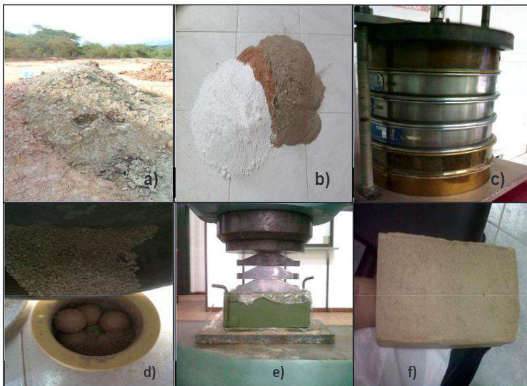
Ilustración 2-7: Proceso productivo del ladrillo refractario
