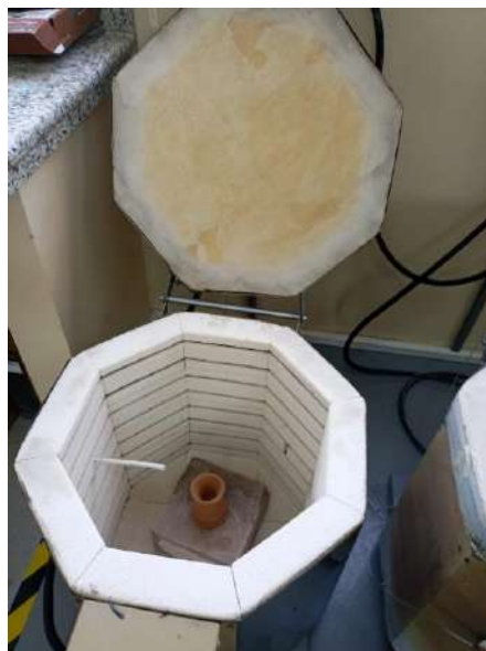
Ilustración 4-17: Proceso de precalentamiento con una pieza de cerámica
