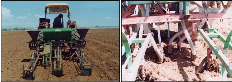
Ilustración 2-2: Sembradora, fertilizadora y pileteadora. Distribución de la semilla y el fertilizante
