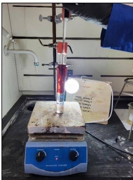
**Ilustración 4-5:** Anilina y fracción líquida miscibles a 63°C
