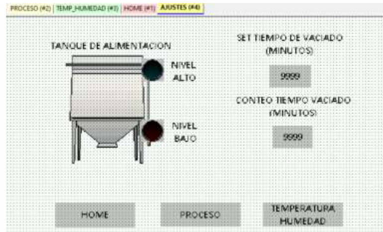
Ilustración 4-7: Interfaz gráfica del tanque de almacenamiento
