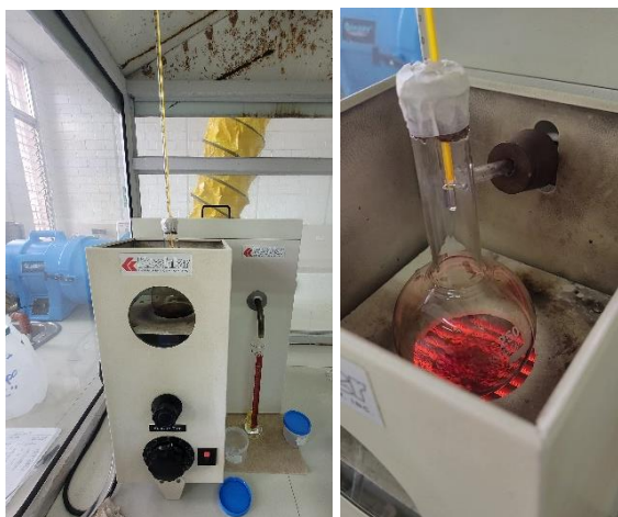
Ilustración 3-11: Equipo de destilación
