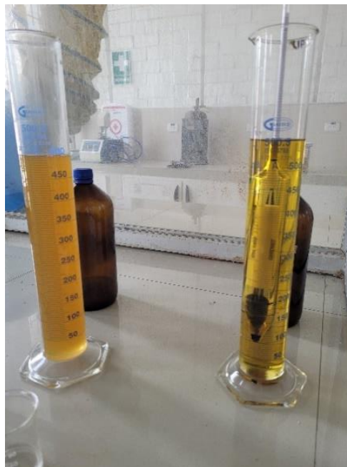
Ilustración 3-9: Determinación de la densidad API
