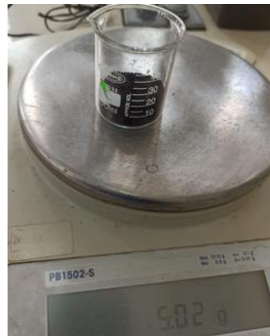
16. Pesaje de carbón activado para elaboración de filtro
