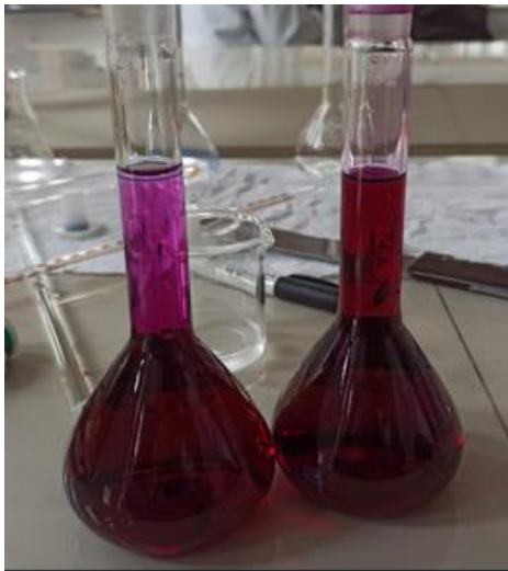
23. Titulación de muestras filtradas ( H_3PO_4 35%)
