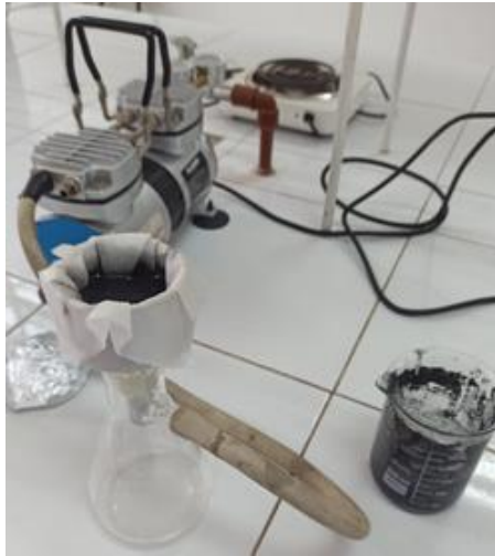
7. Lavado y filtrado de carbón activado
