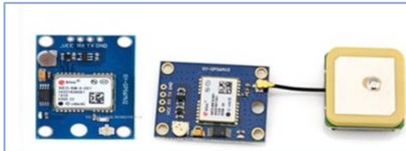
Ilustración 3–10: Modulo Ublox Neo-6M GPS
