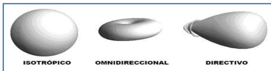
Ilustración 2-16: Tipos de Antenas de Radiofrecuencia
