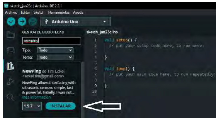
Ilustración 3-15: Instalación de la librería NewPing
