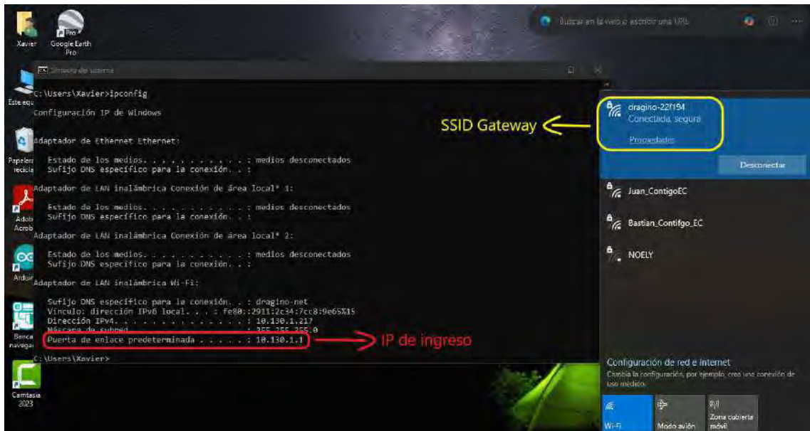
Ilustración 3-35: Selección de red y verificación de IP
